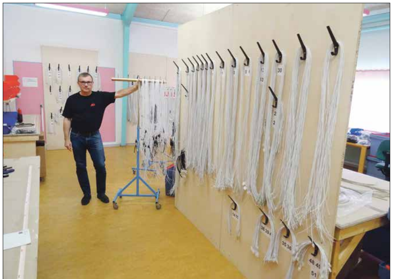
Jesper Borup i et af AD Cuts nye "opgavelokaler", hvor man fremstiller komplekse kabeltræer til en truckkunde. Et skift fra farvede til fuldt opmærkede hvide kabler har forenklet logistikken og givet kunden et langt bedre og mere intelligent produkt.
